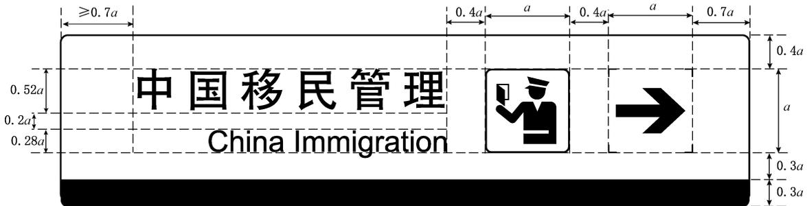
图 29 导向标志横向布置规格
