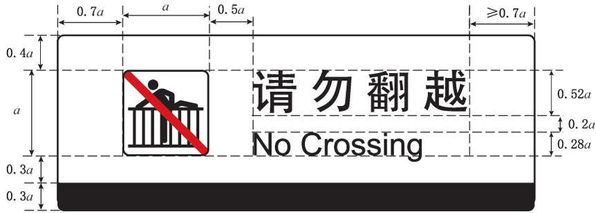
图 26 请勿停留、请勿使用手机、请勿翻越、请勿抛物、请勿通行和请勿入内 6 个劝阻标志规格
