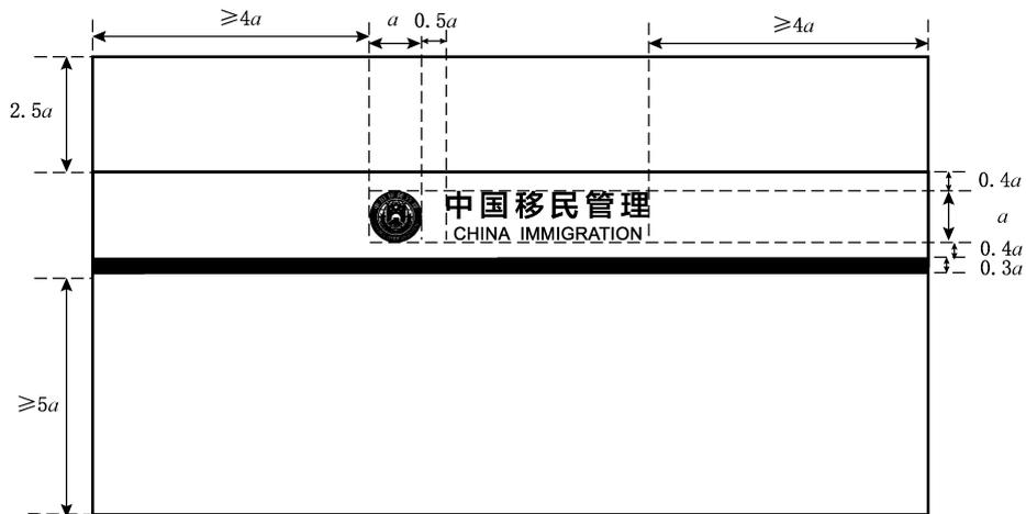
图 13 硬隔离设施标志规格
