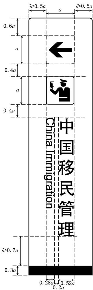
图 30 导向标志纵向布置规格
