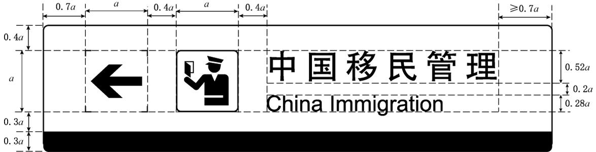
图 28 导向标志横向布置规格
