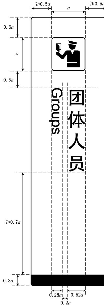
图3 纵向布置的标志规格样式
