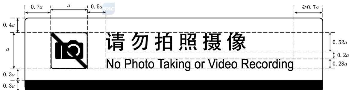
图 25 请勿拍照摄像和非机动车辆请勿通行 2 个劝阻标志规格
