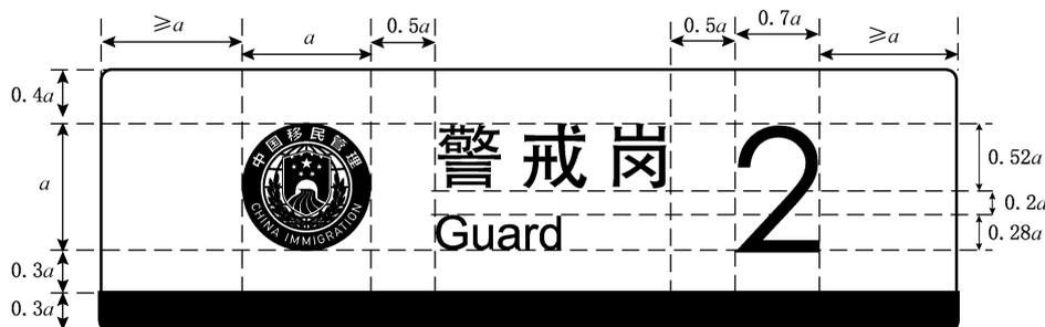
图10 办案区、询问核查区、询问室、等候室、报检室、警戒岗(普通)和监护岗(普通)7个设施标志规格
