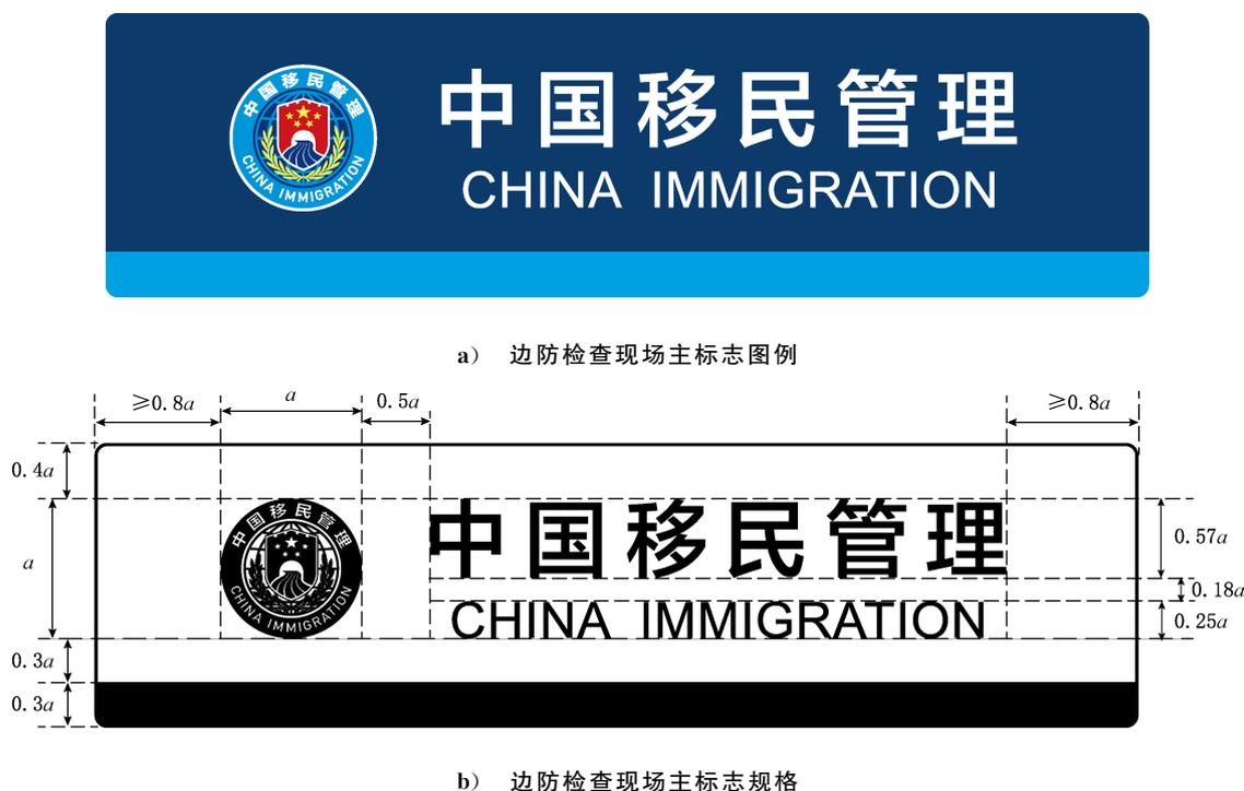
图 4 边防检查现场主标志图例和规格
