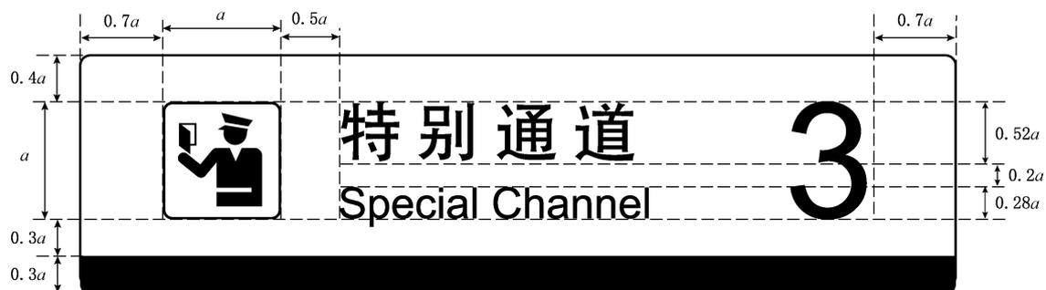
图 5 通道标志(除通道号标志外)的横向布置规格
