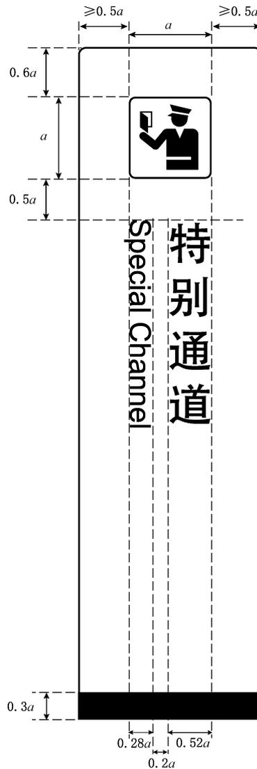
图 6 通道标志(除通道号标志外)的纵向布置规格
