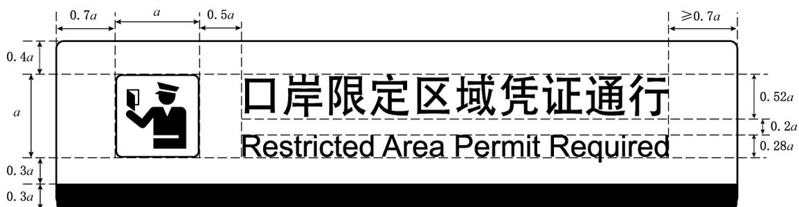
图 23 口岸限定区域凭证通行、请在黄线外排队候检、请主动配合检查、设备检修维护、电子监控区域、请保持安静和通道关闭 7 个提示标志规格
