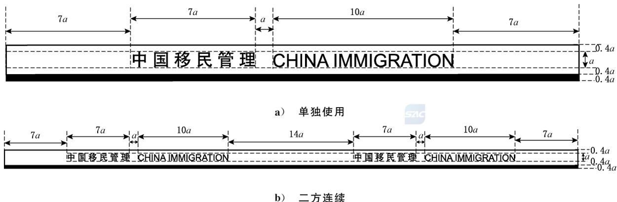
图12 软隔离设施标志规格
