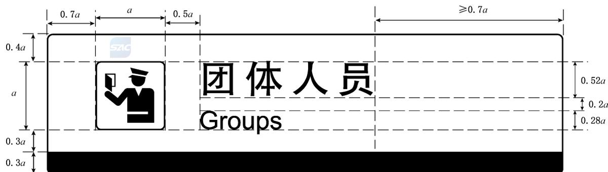
图 2 横向布置的标志规格样式
